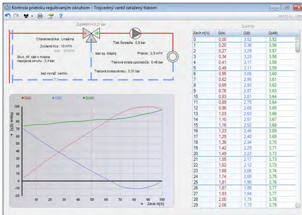
Obr. 2.15. Priebeh zmiešavania pri lineárnej charakteristike
