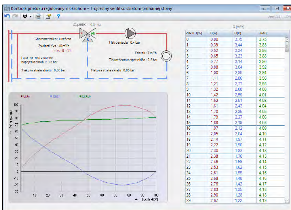
Obr. 3.33. Predimenzovaný trojcestný ventil so skratom primárnej strany
